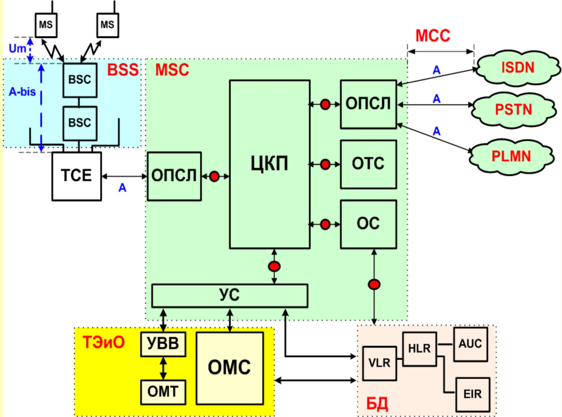
**В состав системы коммутации с подвижными объектами входят следующие подсистемы:**
